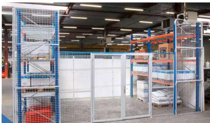
Cloison installée en extrémité d'allée de rack avec une porte à rail rétractable pour une libre circulation des engins de manutention.
