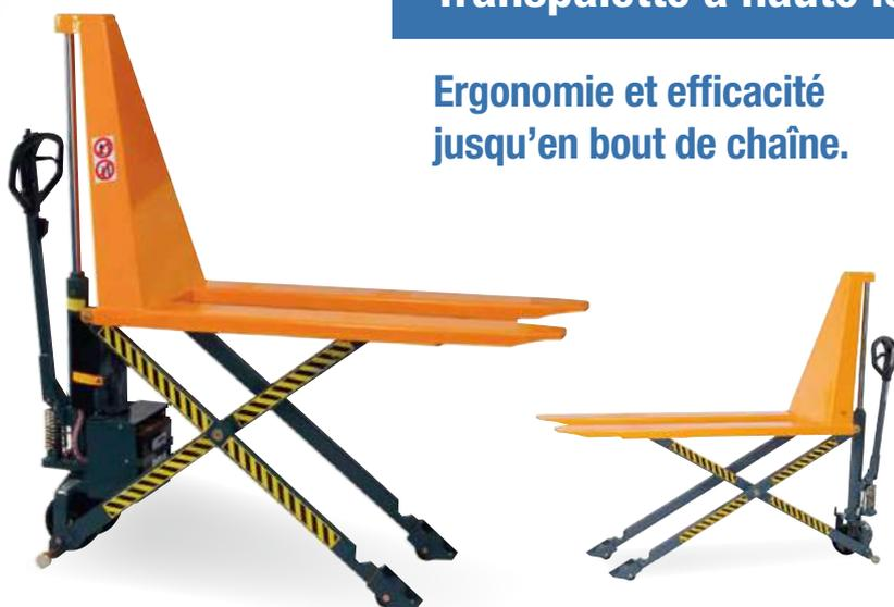
Encombrement restreint, batterie et unité moteur placées entre le corps et le vérin de levage
