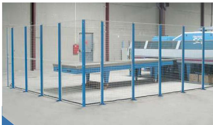
Mise en place autour d'une poinçonneuse pour une meilleure organisation et une protection du poste de travail.
